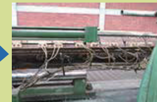
Après le Kaizen. La machine n'a plus de fuites d'huile et les câbles électriques sont en ordre.
